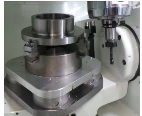
Mit der CNC Universal Rundschleifmaschine S31lean von Studer haben wir unseren Maschinenpark weiter ausgebaut. Für die rationelle Fertigung von Werkstücken mit Innen- und Aussenpartien wurde zusätzlich zu den zwei Aussenschleifscheiben noch eine Innenschleifspindel mit 60'000U/min angebaut.
