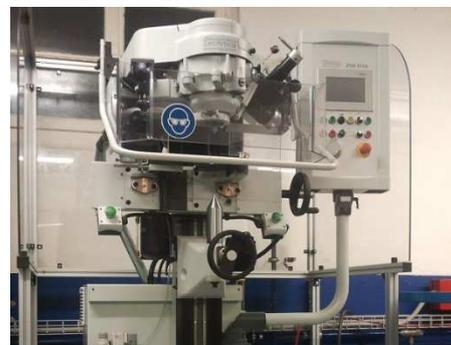
Grössere Flansche, Hülsen oder Spindeln sind seit Mai 2015 willkommene Aufträge. Die neue Drehbank ermöglicht uns das Drehen bis zu einer Länge von 2000mm und einem Durchmesser von 450mm. Mit angetriebenen Werkzeugen, Reitstock und einer programmierbaren, servogetriebenen Lünette erhöhen wir unsere Fertigungstiefe für grössere Werkstücke.
