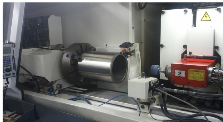
Rundschleifen bis Ø 450, Länge bis 1600 mm
