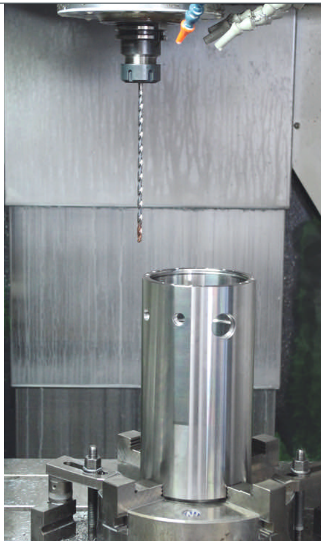
4 Die Vollhartmetall-Hochleistungsbohrer von Sphinx Werkzeuge ermöglichen Prozesssicheres Fertigen auf Bearbeitungszentren bei nur 20 bar Kühlmitteldruck
