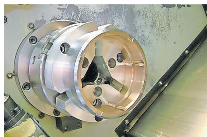
Von Ingold Tools hergestellte Segmentbacken aus hochfestem Aluminium 7075.
