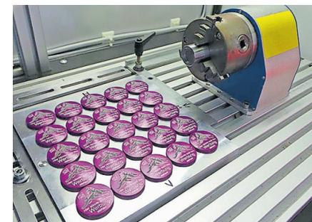
Mit einer Foba-Laserbeschriftungsanlage werden tiefe Gravuren sowie feinste Beschriftungen auf Mantel- und Planflächen gelasert so wie bei den hauseigenen Powermagneten.
